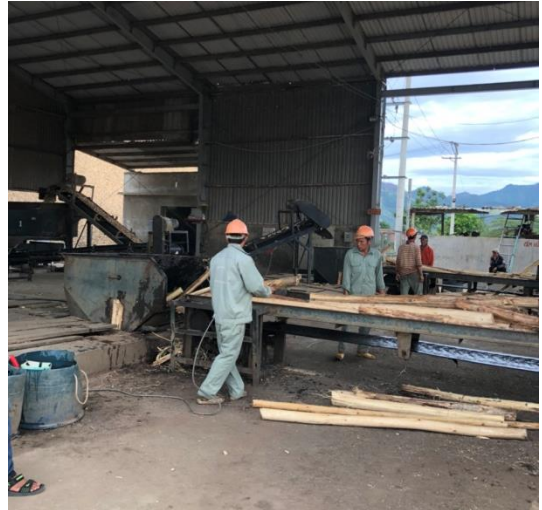
Máy băm dăm đặt ngầm – có tôn cản bụi dăm ra bằng tải
